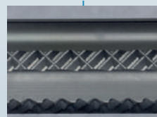
Crossverzahnung schiebend Cross toothing, downcut
