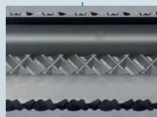
Crossverzahnung ziehend Cross toothing, upcut
